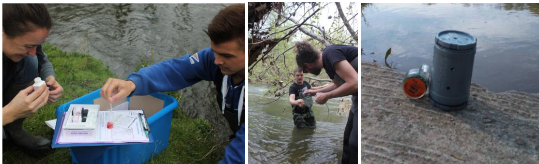
Figure 5 : Mesure de dureté de l'eau – Mise en place d'un thermomètre – Thermomètre et étui
