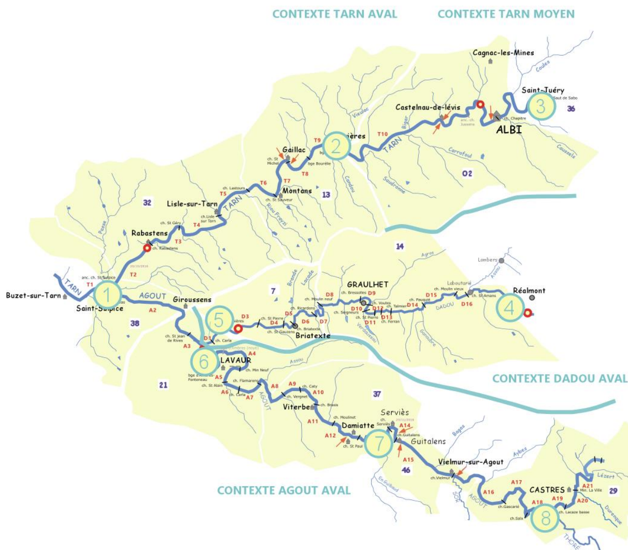
Figure 30 : Zones prévues pour la mise en place des stations de mesures de température
