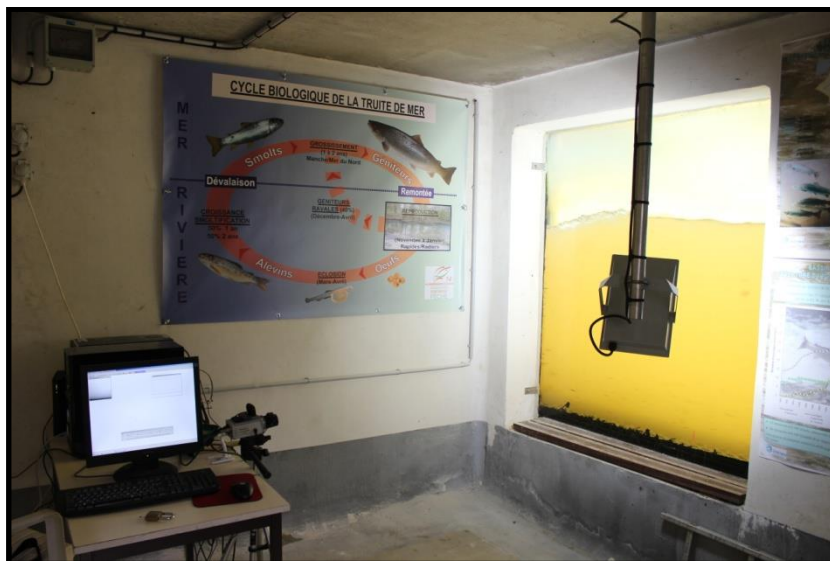
Figure 4 : Exemple de dispositif de vidéocomptage
