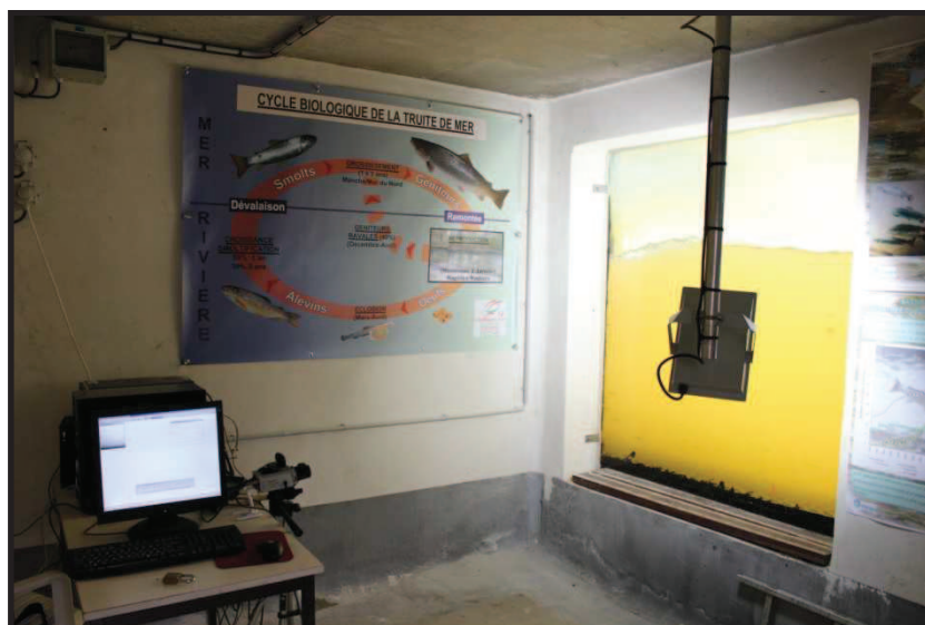
Figure 4 : Exemple de dispositif de vidéocomptage
