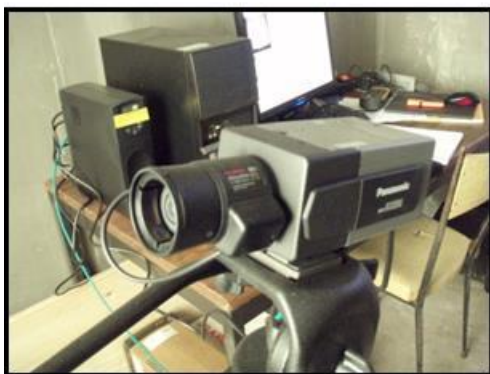
Figure 4 : Dispositif de vidéocomptage
