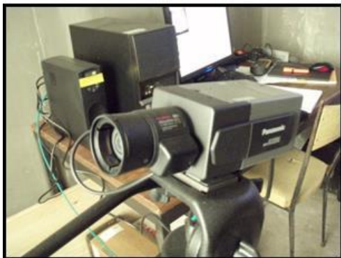
Figure 4 : Dispositif de vidéocomptage
